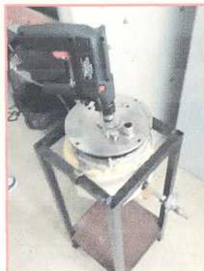
La instalación experimental mostrada consta de un reactor discontinuo agitado. En la parte
